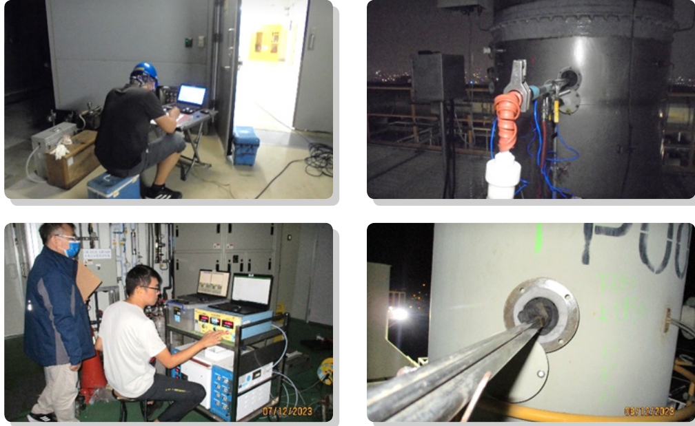
廠商排放管道抽測作業
