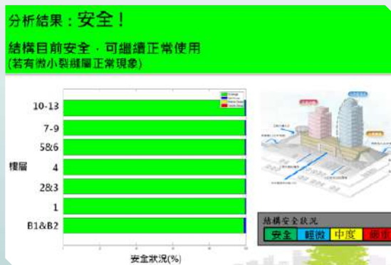
結構安全監測系統可於地震發生後快速提供結構物健康診斷與安全評估
